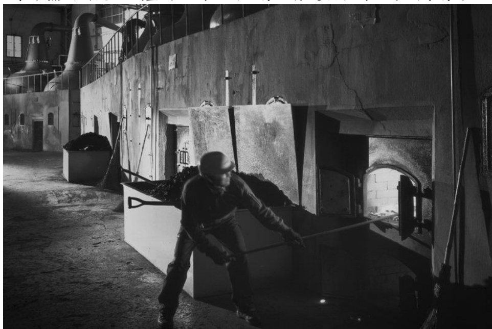
圖 3：余市蒸餾所最特別的，是世界上只剩它仍使用「石炭直火式蒸餾」，製造出來的威士忌帶有炭火煙熏味的濃烈口感。 24
