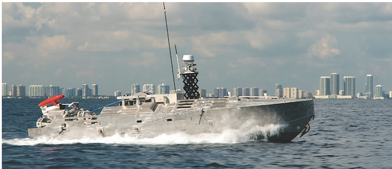
德事隆(Textron)公司的「通用無人水面載具」(Common Unmanned Surface Vehicle)，能在其井圍甲板上執行各種不同任務。此一載具可跟各種有人與無人艦艇及感測系統搭配，成為未來水雷反制系統的骨幹。(Source: Textron Systems)
