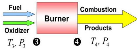
圖3. 本文計算燃燒室絕熱焰溫採用的0-D模型。
