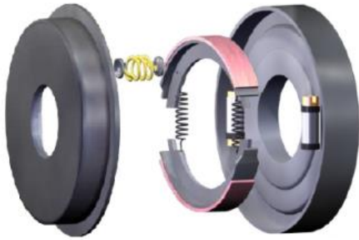
圖 1、鼓式煞車構造圖
