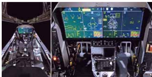
圖四 以「大型全景式座艙顯示器」(Panorama Cockpit Display—PCD)為屏幕的F-35座艙布局，遵循「飛行員載具介面」(Pilot Vehicle Interface—PVI)的設計哲學。
