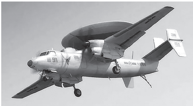
此為「空警—600」固定翼艦載預警機CG圖，頂部天線罩內安裝大功率相控陣雷達，可用於搜索、探測、識別和跟蹤距離四百五十至六百公里以內的空中和水面目標。
