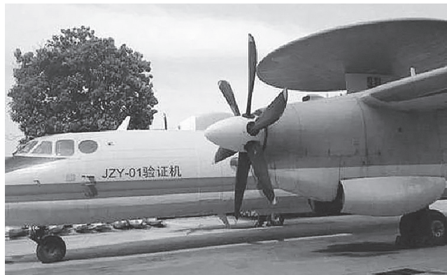
「JZY-01」驗證機是「空警—600」的原型機，目前中共仍在研究最佳配置、機載雷達尺寸及測試涉及其他構造方案上的問題。
