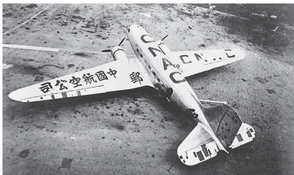
一架中國航空公司停在地面的DC-3型運輸機整個右機翼炸掉，當時沒有DC-3型機的機翼可替換，中方機械士找到一隻DC-2型機的右機翼替換。
