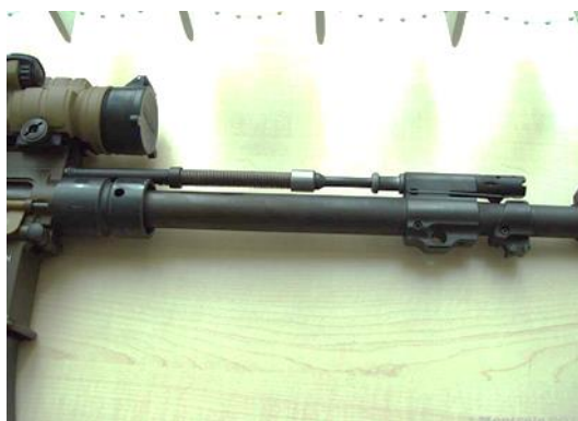
圖九：HK 416A5瓦斯調節器及復進機構
