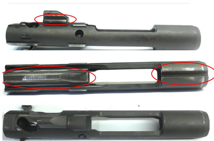
圖十二：傳統施鍍磷酸鹽塗層磨損
