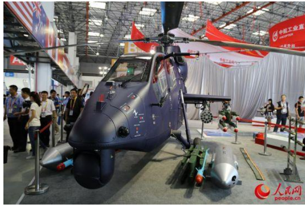
圖五 直 19E 攻擊直升機感測器旋轉塔
