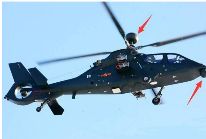
圖四 直 19E 攻擊直升機偵蒐雷達與前方感測器
