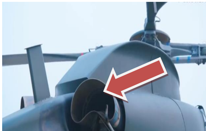
圖七 直-19E 攻擊直升機發動機排氣尾管造型可具有抑制紅外線尋跡效果
