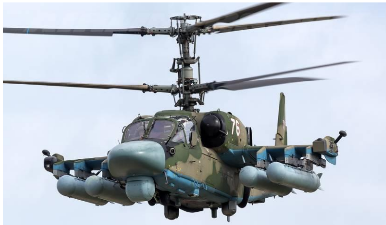
圖九 俄羅斯 KA-52 短吻鱷攻擊直升機獨特的同軸反轉雙旋翼配置
