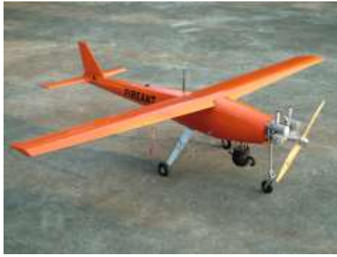
圖三 紅火蟻三型靶機外觀圖
