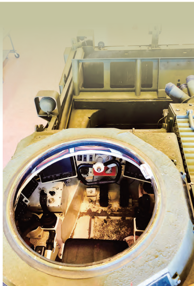
現代化M9型裝甲戰鬥堆土機是一款全履帶式裝甲戰鬥工兵車。(Source: USMC/Ted Schmit)
