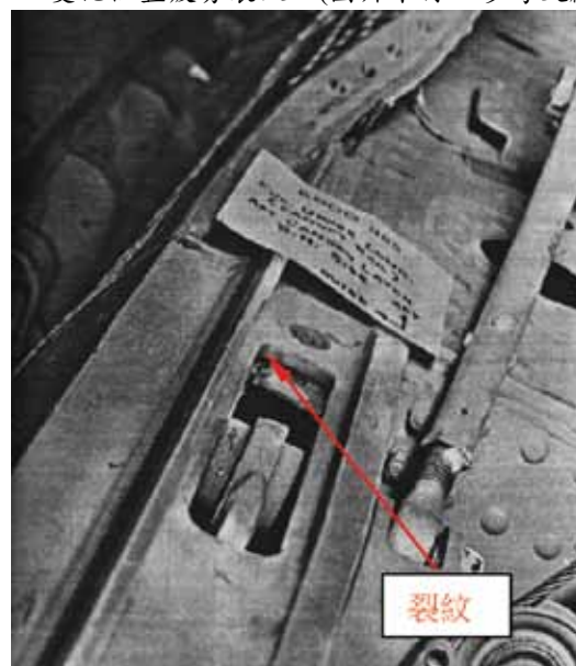
圖八 右側座艙上縱樑位機身站位FS 257座艙罩鎖勾開口位置疲勞裂紋。(圖片來源：參考文獻7)
