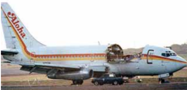
圖十七 美國阿羅哈航空公司一架波音737客機前機身蒙皮因腐蝕疲勞裂紋而飛脫。(圖片來源：參考文獻9)
