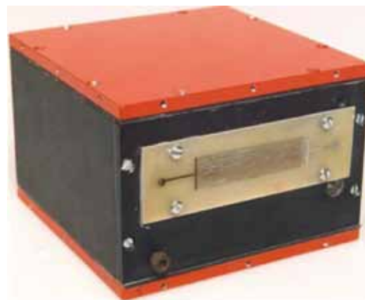
圖廿二 澳大利亞空軍F-111及P-3C機隊安裝的腐蝕偵測器。(圖片來源：參考文獻17)
