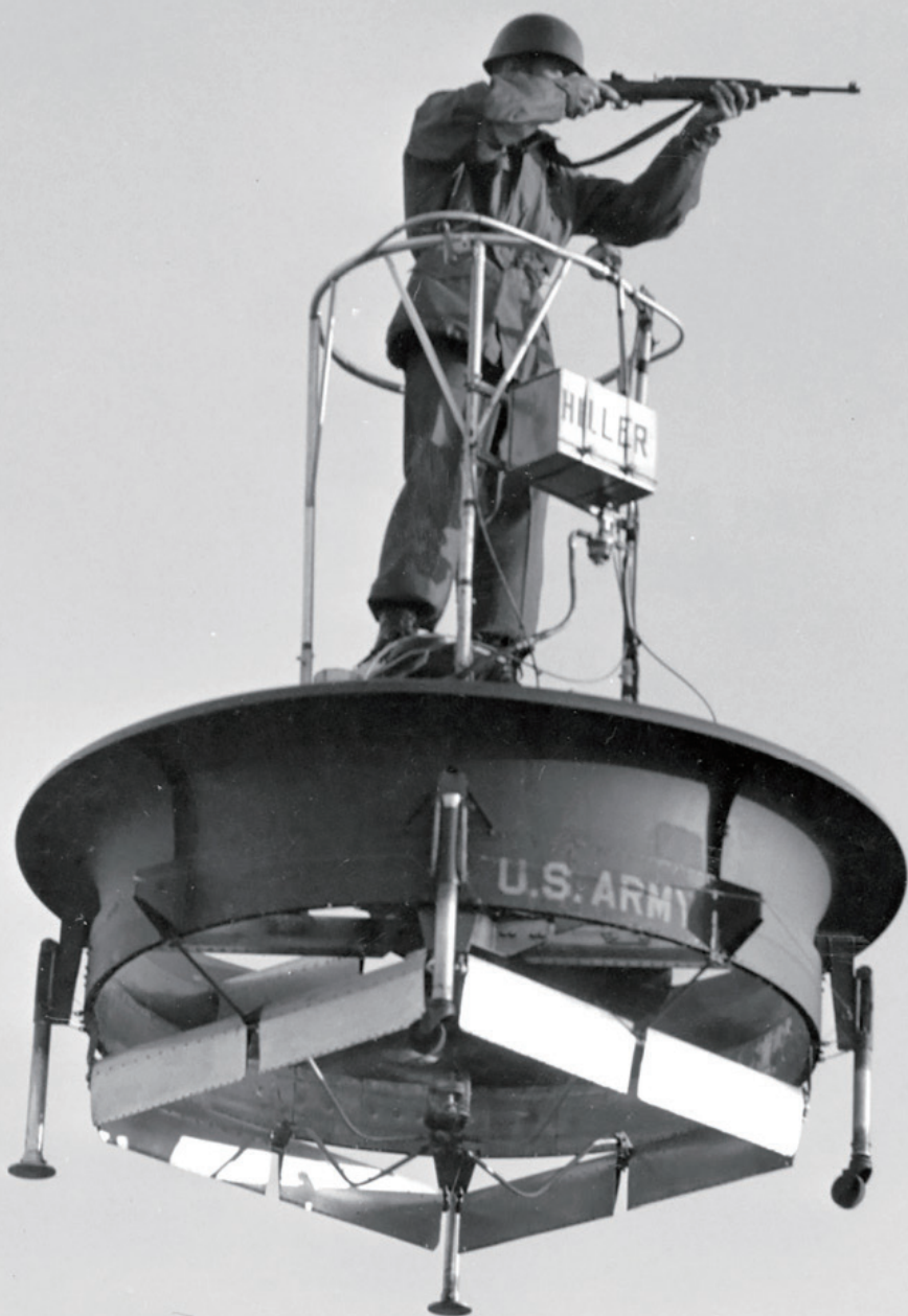
1958年進行系統驗證的希勒(Hiller)公司VZ-1波尼(Pawnee)飛行載臺。(Source: National Air and Space Museum, Smithsonian Institution)
