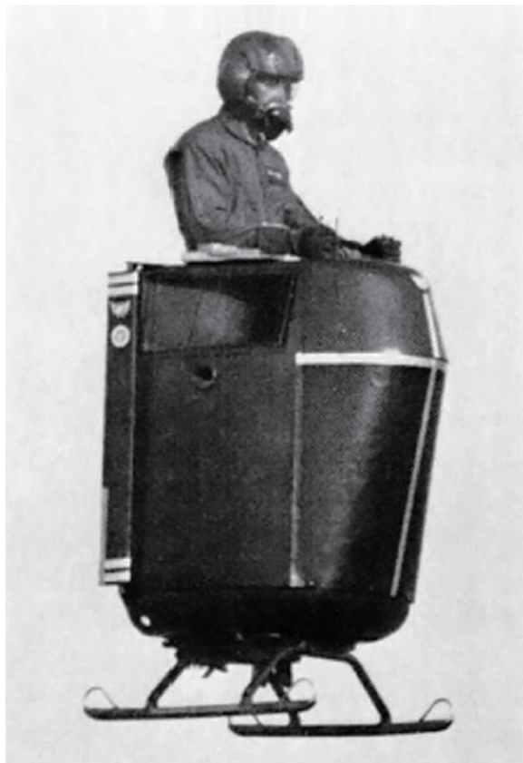
一種可垂直起飛且能讓人員以時速60哩飛行30分鐘的渦輪動力個人飛行器，已經由軍隊實施過一系列的自由飛行測試。此種飛行器名為「威廉斯飛行系統載臺II號」，其在1980年代的美陸軍與步兵委員會中曾被視為可能採用的個人飛行器選項。(Source: US Army)
