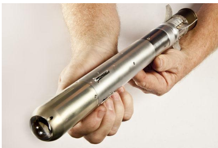
圖七 後方彈翼展開狀態
