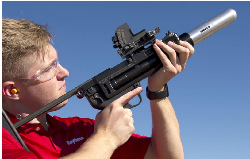
圖二 40 公厘榴彈發射器射擊長矛飛彈
