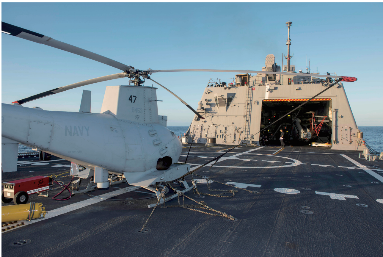
MQ-8B型火力斥候無人遙控直升機，可為有人系統鎖定目標，並幫助導引武器發射後擊中目標。
