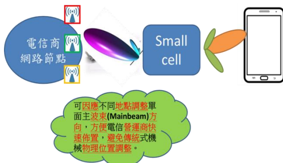
圖 16 支援 3GPP Backhaul 機制示意圖
