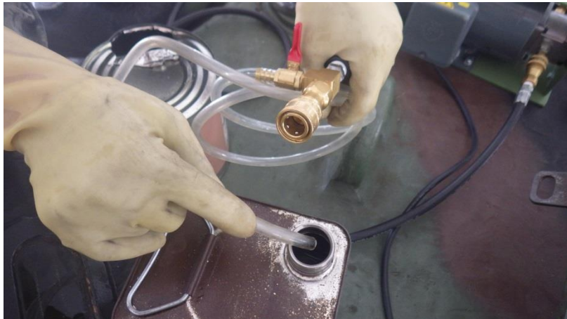
圖 49、透明軟管末端置入空容器
