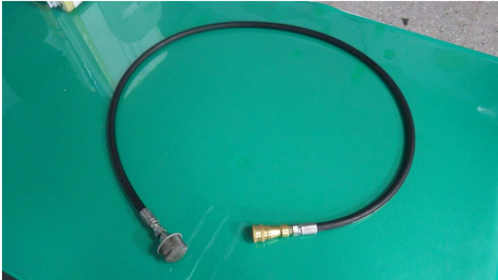
圖 3、輸入高壓油管總成
