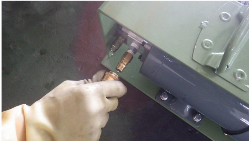
圖46、連接輸入端油管
