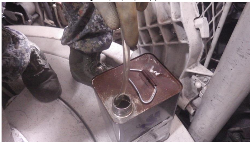
圖 61、透明軟管末端置於空容器
