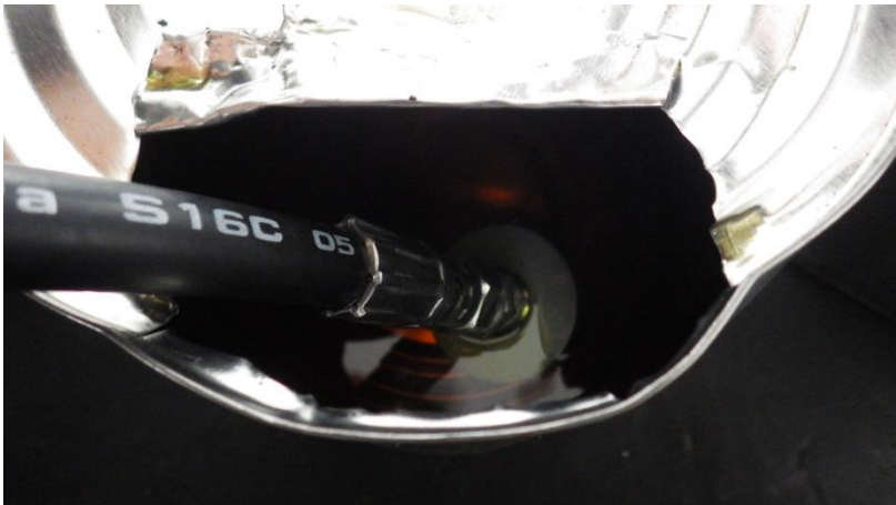
圖48、濾網置入液壓油容器
