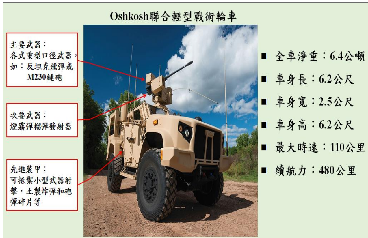
圖 16：Oshkosh 聯合輕型戰術輪車諸元簡圖
