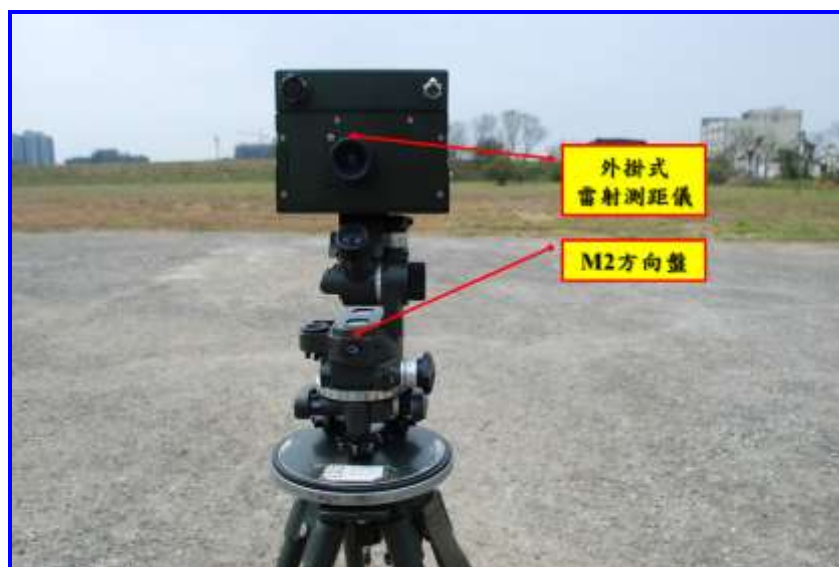
圖廿一 本研發案-「M2 測距方向盤」
