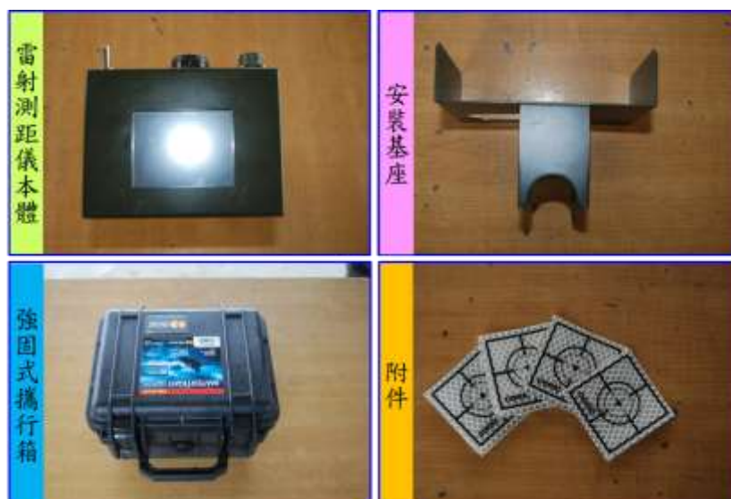
圖五 「外掛式雷射測距儀」四大組成示意
