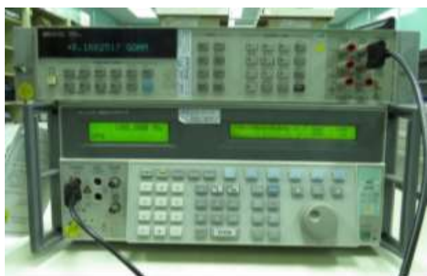
圖三 量測常用標準件（FLUKE 5500A） 5
