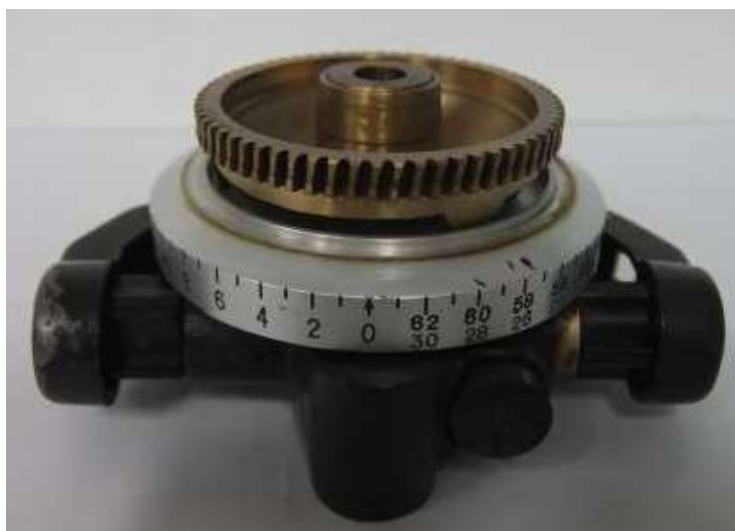
圖四 M2 方向盤分割度盤之銅質「精密齒輪」 資料來源：作者自製
