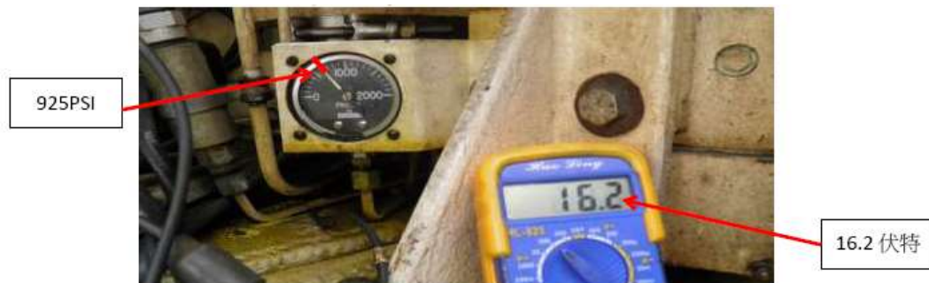
圖六 啟動後之電壓變化
