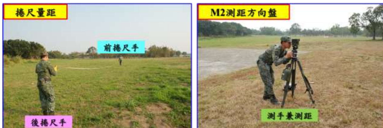
圖廿三 「M2 測距方向盤」可令測手同時實施角度與距離觀測示意
