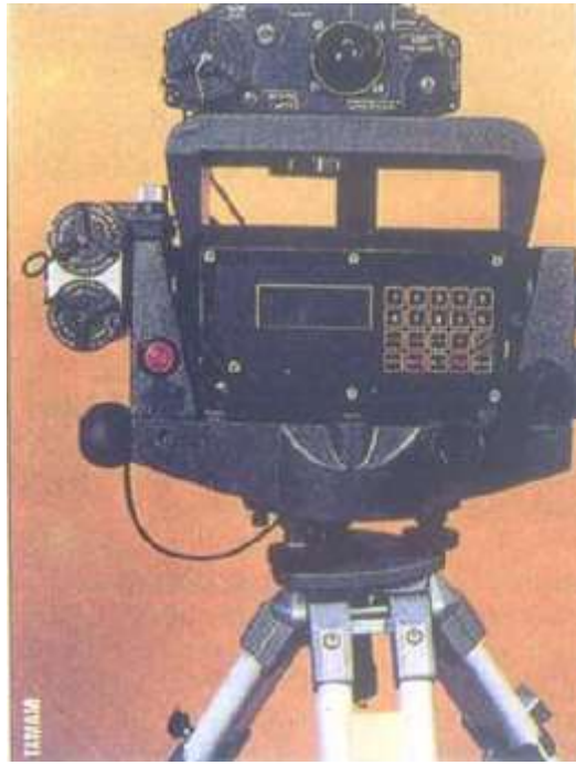
圖十 以色列 TAMAM 工業生產之「定北/射向賦予系統」(NFS/GLS)
