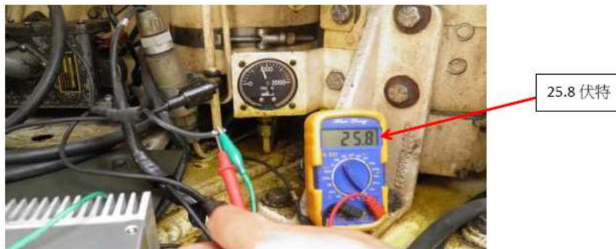
圖五 未啟動時之電壓
