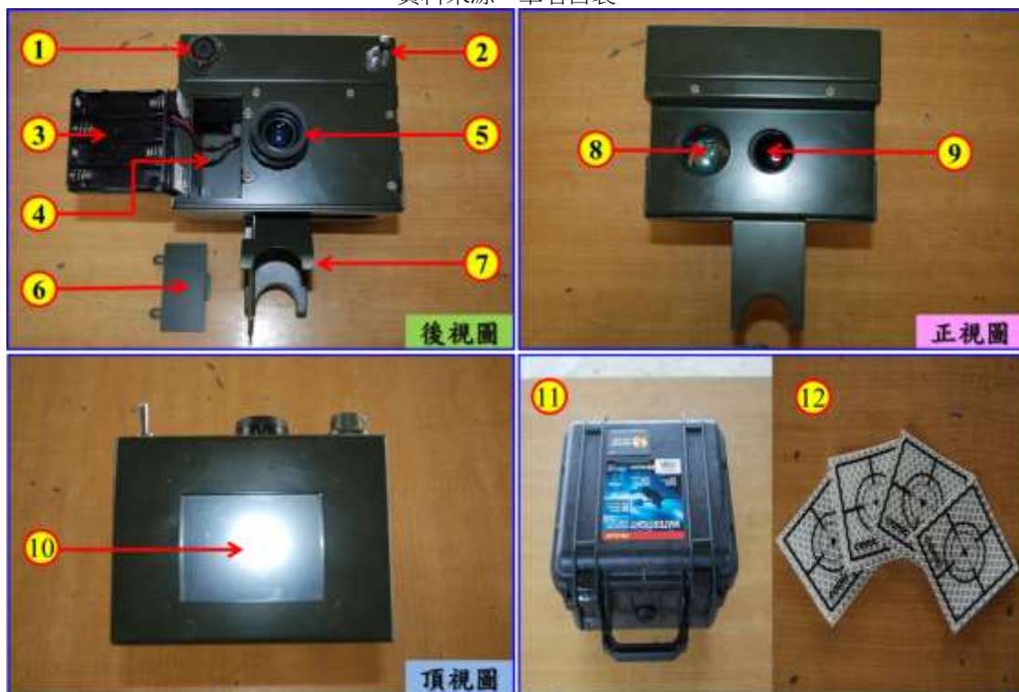
圖十 「外掛式雷射測距儀」各部名稱與功能示意
