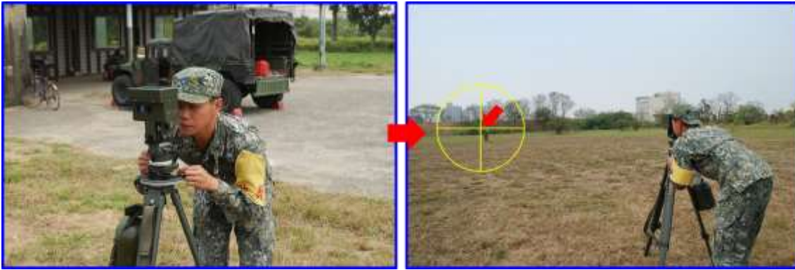
圖十五 「M2 測距方向盤」精確標定目標示意
