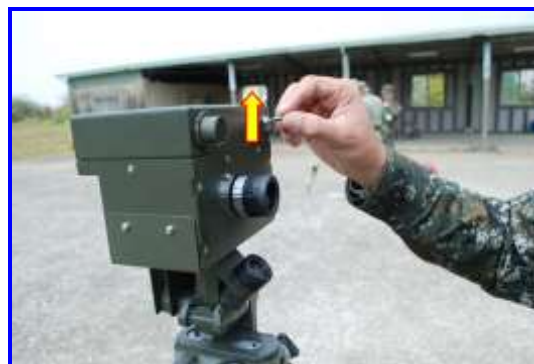
圖十三 開啟「M2 測距方向盤」電源開關
