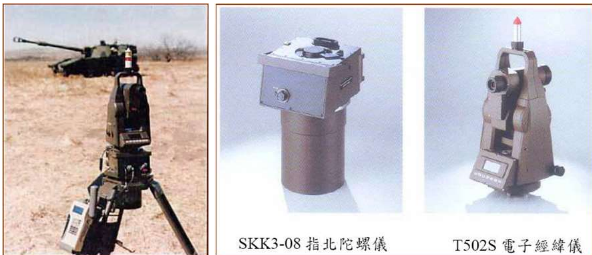
圖十九 美軍砲兵連（排）編配之「火炮射向賦予與定位系統」（GLPS） 資料來源：耿國慶，「砲兵方向盤發展與運用之研究」，砲兵季刊，第 163 期（民國 102 年 11 月），頁 7。
