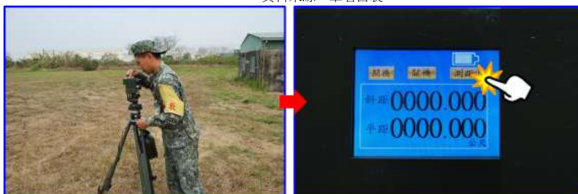
圖十六 壓觸「測距鍵」實施快速測距示意
