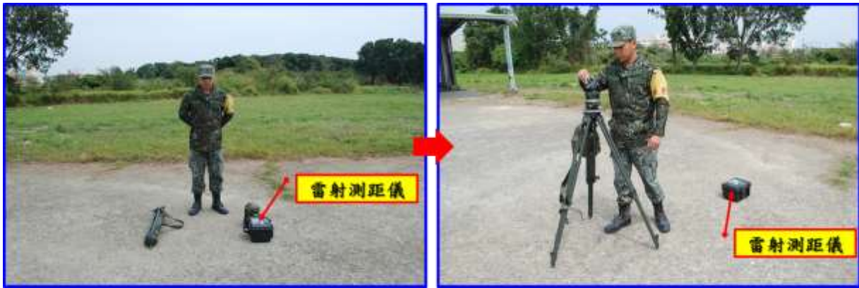
圖十一 M2 方向盤器材整置示意
