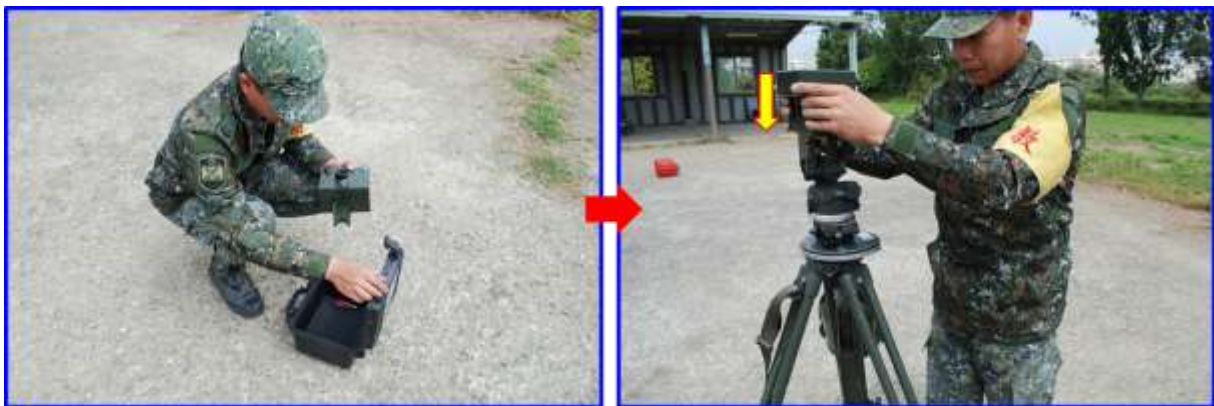
圖十一 M2 方向盤器材整置示意
