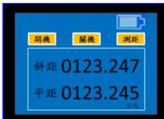
圖十七 看讀「M2 測距方向盤」之傾斜（與水平）距離示意
