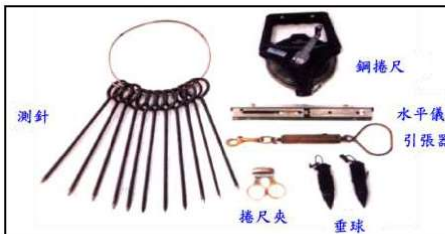
圖四 原編制於砲兵營、連 17、18 號測量成套器材中之全套捲尺器材
