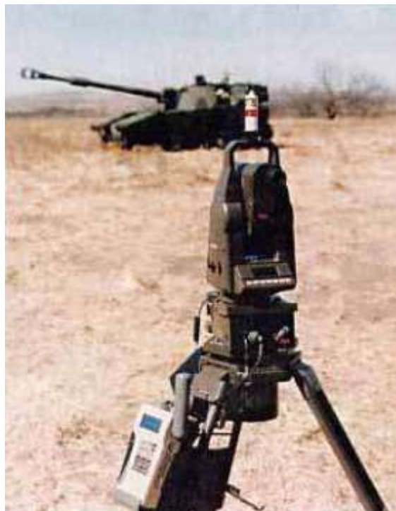
圖七 美軍砲兵連（排）編配之「火炮射向賦予與定位系統」（GLPS） 資料來源：Gun Laying and Positioning System (GLPS). Leica Geosystems AG Defense & Special Projects. 9/2002.
