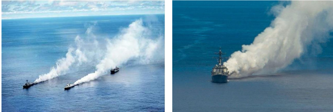
圖 5 美軍艦艇煙幕反制攻艦飛彈
