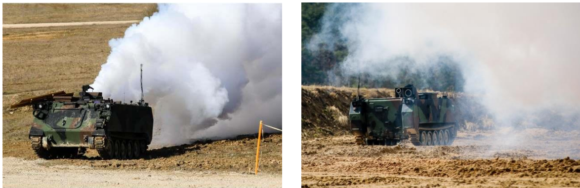
圖 7 M58 狼式渦輪發煙機運用遠端控制實施煙幕作業
