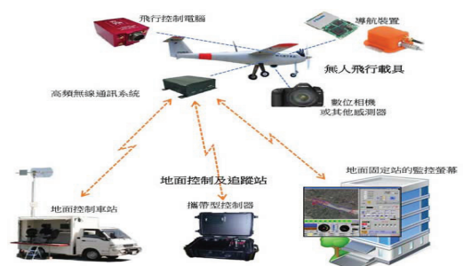
圖 5. 無人航空系統(UAS)的基本組成
