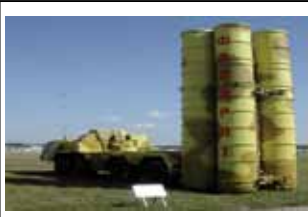
5P85SE自行式運輸車安裝發射器
