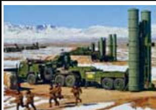
5P85TE2牽引式運輸車起重 機發射器
