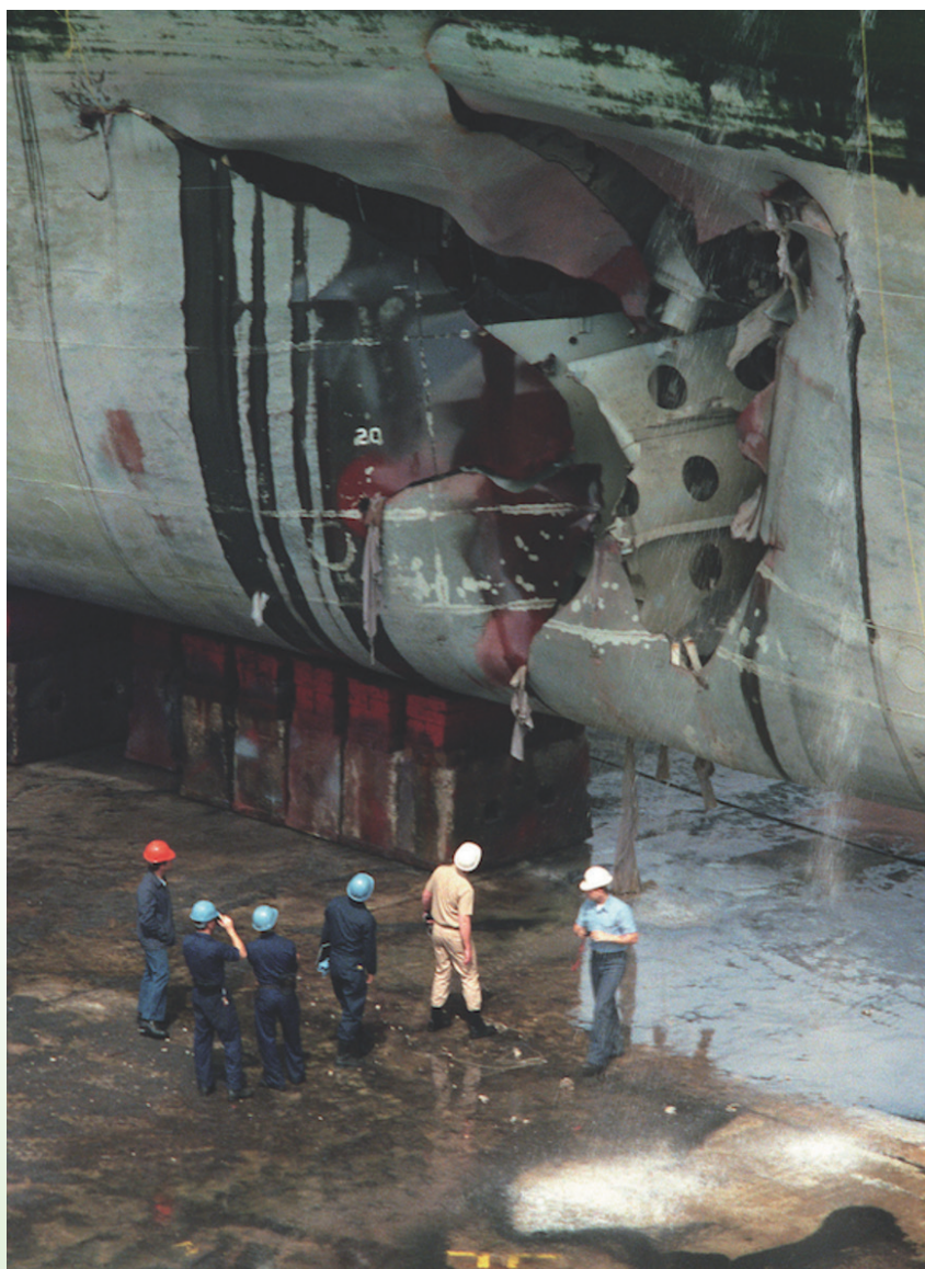
1991年，美海軍的黎波里兩棲突擊艦碰觸伊拉克水雷導致右舷破洞嚴重受損。(Source: Wiki)
