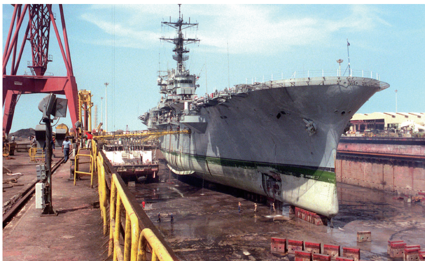
1991年，美海軍的黎波里兩棲突擊艦碰觸伊拉克水雷導致右舷破洞嚴重受損。(Source: Wiki)
