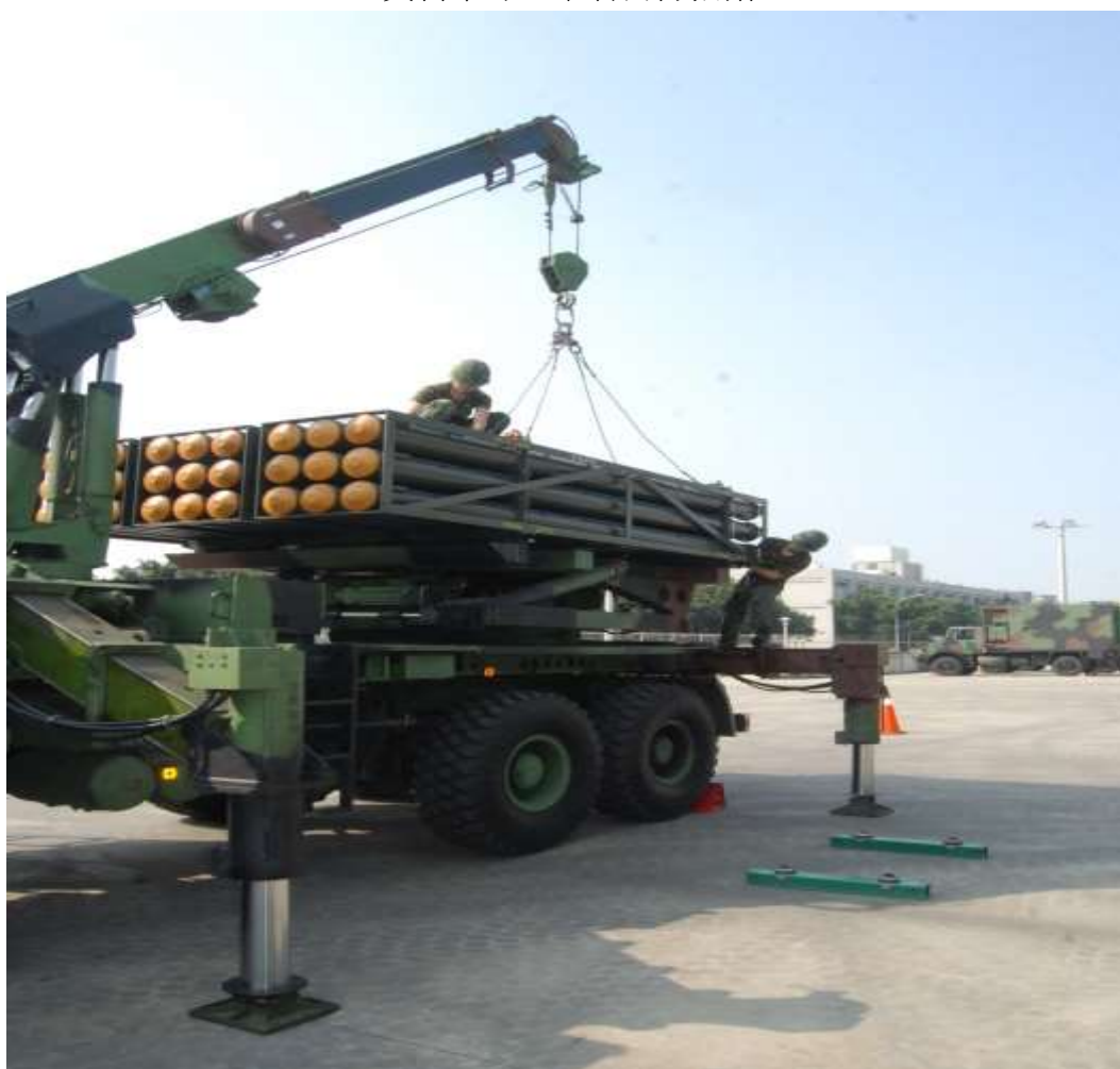
圖十一 雷霆 2000 MK - 30 訓練彈箱卸載作業
