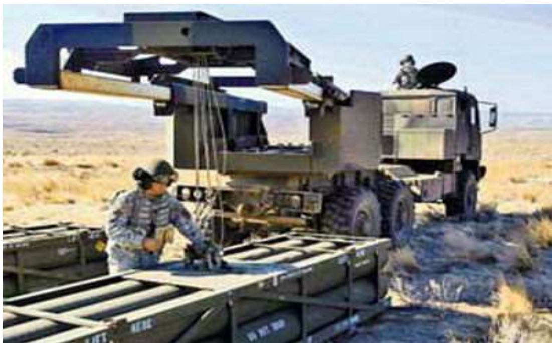
圖十三 HIMARS 多管火箭彈箱夾艙吊掛作業情形
