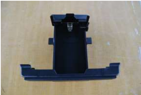
圖十二 車用安裝架（正視圖）
