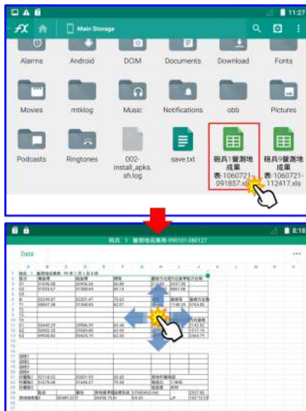
圖二二 電算機自動產製「測地成果表」檔案示意
