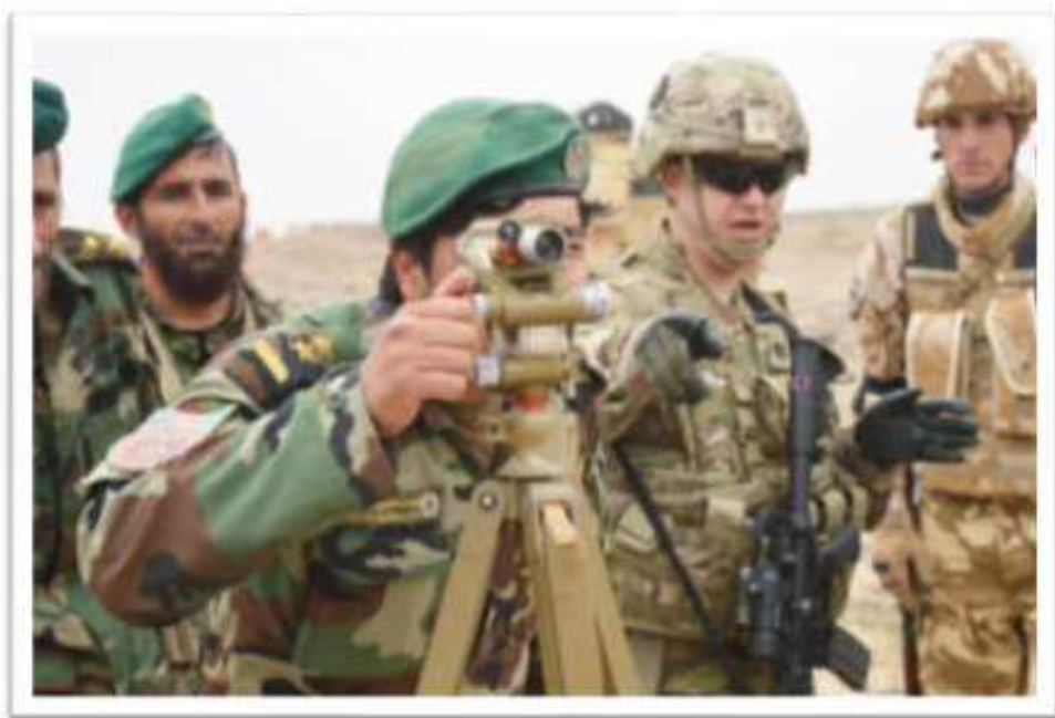
圖九 美軍指導阿富汗國防軍使用中共製造 58 式方向盤射向賦予
