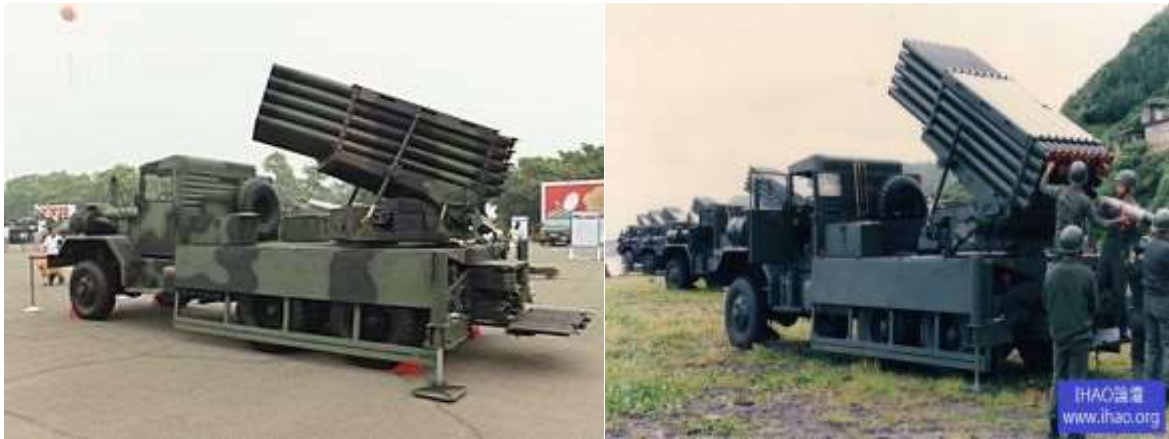
圖二 工蜂六 A 多管火箭、人工裝彈
