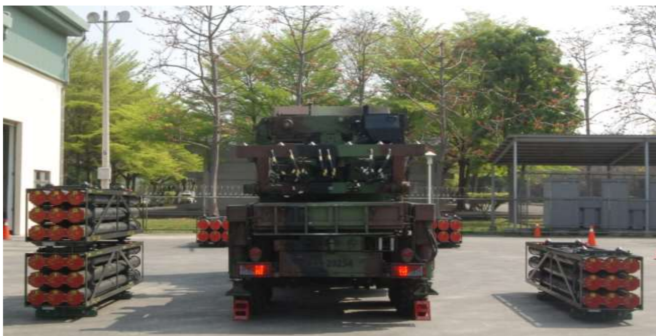
圖四 MK - 30 火箭彈箱構造與訓練場地擺放圖
