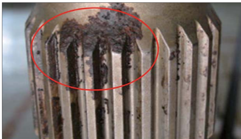
圖三 主承桿鏽蝕圖（資料來源：作者拍攝）
