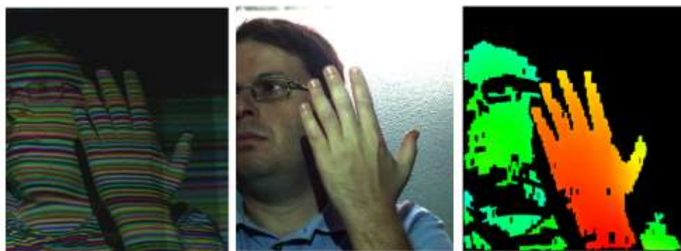
(a)條紋圖像(算深度) (b)真實影像 (c)具深度的手勢影像
