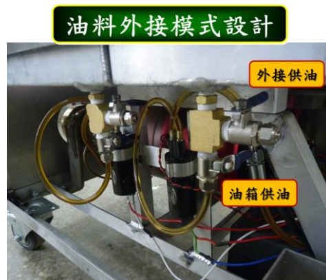
圖25 第三代研改精進-油料外接模式設計
