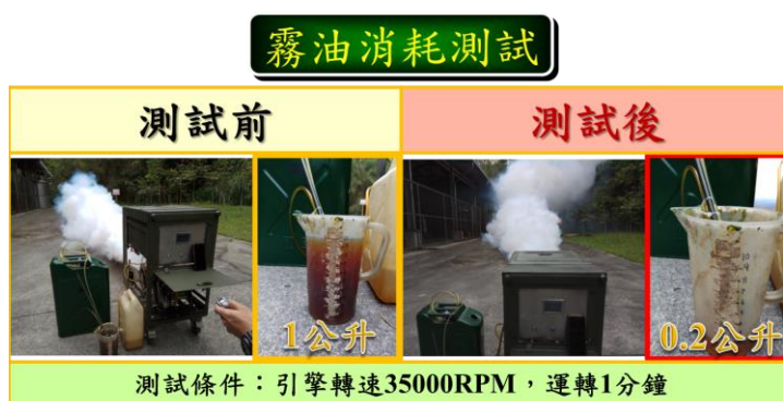
圖28 第二代研改精進-油料外接模式設計
