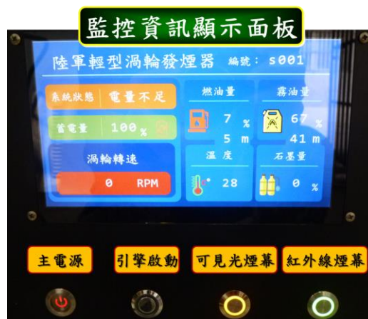
圖19 第三代研改精進-監控資訊顯示操控面板
