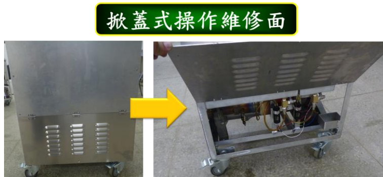
圖24 第三代研改精進-掀蓋式操作維修面
