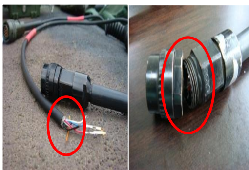
圖 22、頭盔導線接頭損壞
