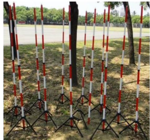
圖八 標桿可依狀況伸縮、輔助腳架可架設於硬質地面
