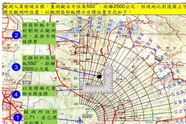
圖十一 極座標法標示目標作業方法
