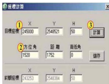
圖十四 將GPS接收座標使用數據輸入器轉換成UTM座標
