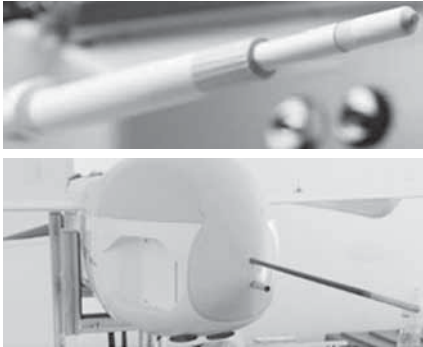
左上圖起順時針方向依序為HMP155溫／濕度感測計、地表溫度感測計、PTB110氣壓感測器與動／靜壓風向風速量測管。
