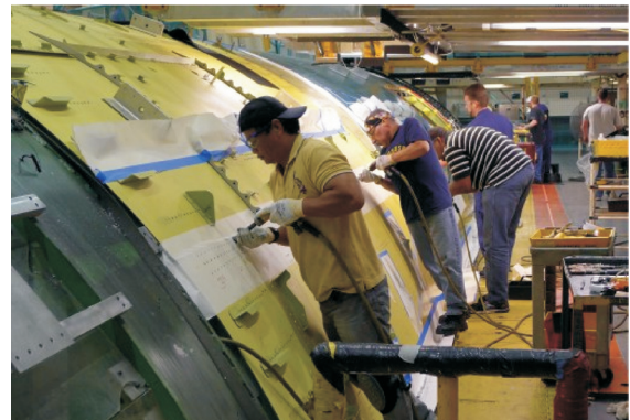
圖十九 B777組裝工具(上)B777機身組裝(下) [20]
