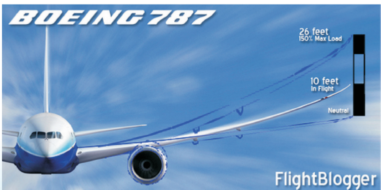
圖七 波音B787主翼翼尖最大位移量：地面、飛行中、到1.5倍最大負載(由下而上)。
