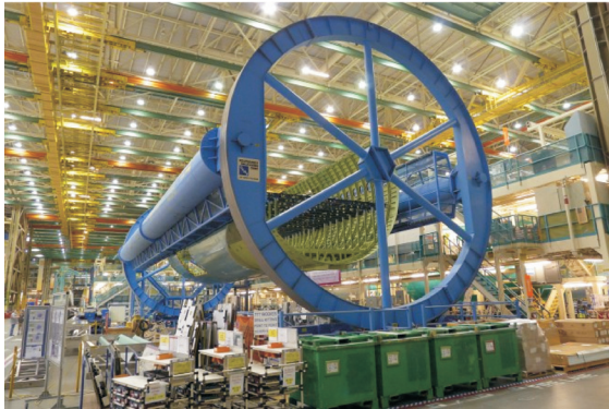
圖十九 B777組裝工具(上)B777機身組裝(下) [20]
