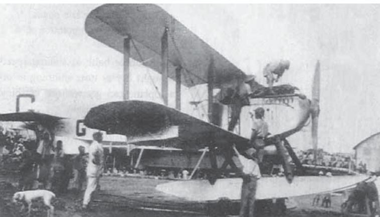
拆卸後由英國裝船運至印度之「法利式」浮筒機嚴重受損，英皇空軍機械士正為之維修。
