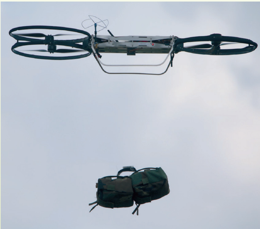
2017年4月12日，奧克拉荷馬州夕爾堡(Fort Sill)舉行機動與火力整合驗證課目時，一架配備「聯合戰術自主空中運補系統」的無人機投放一包小型補給品。(Source: US Army/Monica Wood)
