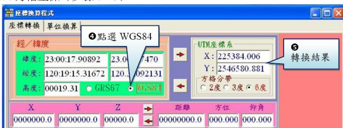
圖十七 利用中科院座標轉換程式將Ⅲ等三角點「頂山」GRS67 轉換為 WGS84、6°UTM 方格座標（步驟 4 - 5）
