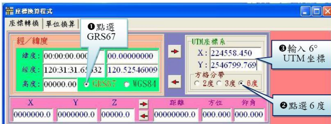
圖十六 利用中科院座標轉換程式將Ⅲ等三角點「頂山」GRS67 轉換為 WGS84、6°UTM 方格座標（步驟 1 - 3）
