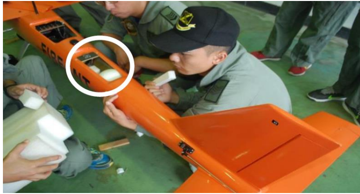
圖十五 靶機加掛輻射增波器
