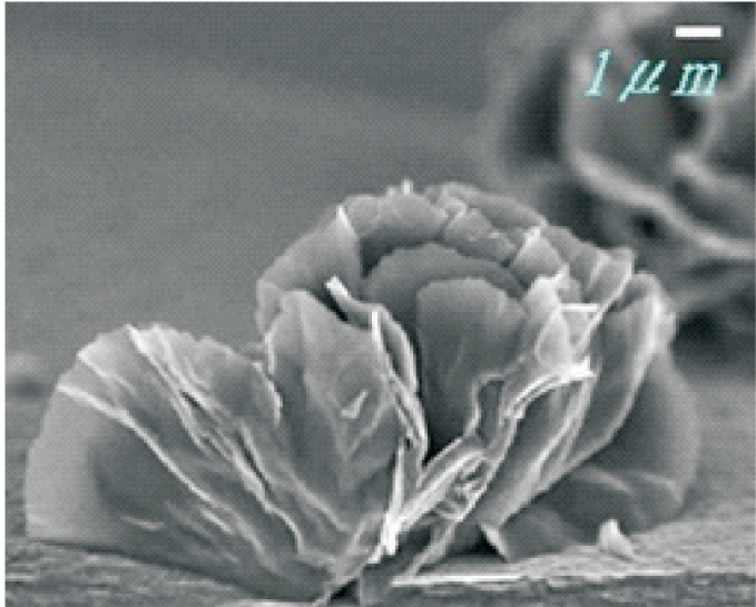
Fig. 7 電漿輔助化學氣相沉積法備製的石墨烯 [30]
