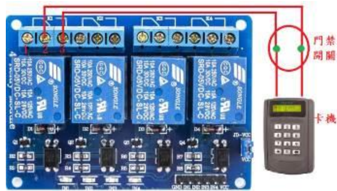
圖十五 繼電器模組接線圖
