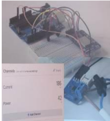
圖十一 Arduino 雲端監控能源消耗架設圖
