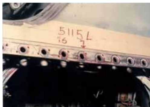
美軍F-5前機身上縱樑應力腐蝕裂紋。 (圖片來源：作者)
