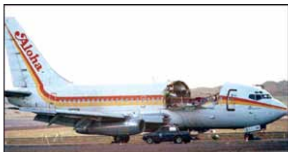
美國阿羅哈航空公司一架波音737客機前機身蒙皮因應力腐蝕裂紋而飛脫。(圖片來源：參考文獻9)
