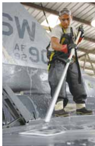
定期清潔飛機可以有效預防腐蝕的提早發生。注意清潔人員身上綁著高空作業安全繩索。(圖片來源：參考文獻12)
