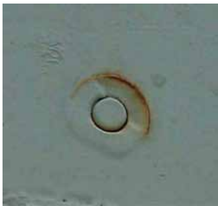
飛機結構螺栓孔處由於螺栓頭和結構接合面縫隙而產生的縫隙腐蝕。(圖片來源：參考文獻19)
