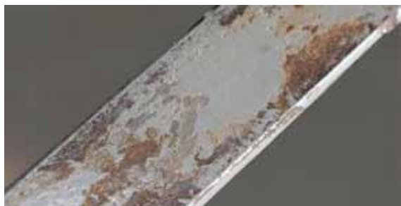
金屬表面的摩擦腐蝕。(圖片來源：參考文獻18)
