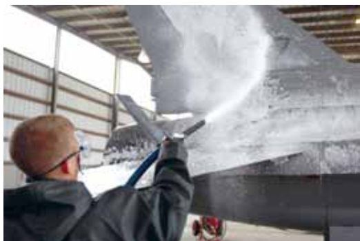
垂直尾翼及水平尾翼下翼面，以泡沫式清潔劑沖洗效果較好。(圖片來源：參考文獻12)
