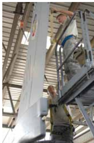
較高的飛機結構部位，需有高台讓清潔人員能完全接觸外表面。(圖片來源：參考文獻12)
