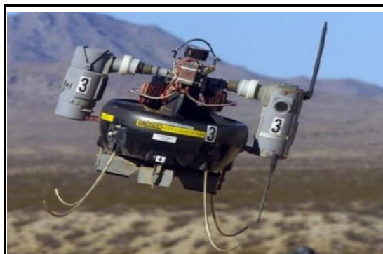
圖 2 美制 T 鷹無人機除可照相外，也可執行空氣取樣。
