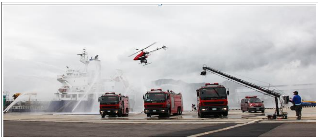
圖 13 空中無人飛行載具執行輻射偵測。
