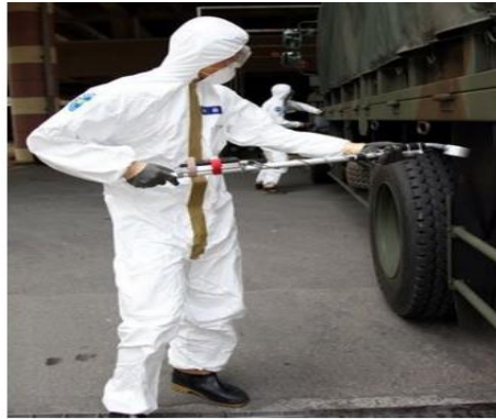
圖 6 化學兵部隊作業人員以手持長柄式輻射偵測器受輻射污染車輛實施偵測。
