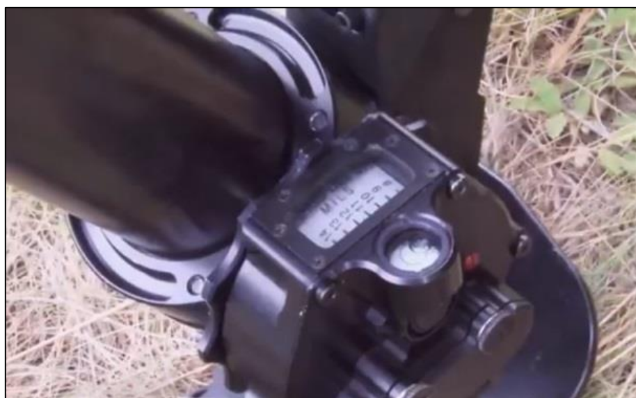
圖十一 砲管提把左側附有射角調節裝置及圓形氣泡
