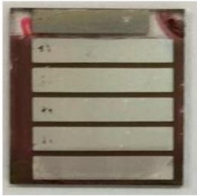
圖 2. 製備之高分子太陽能電池實體照片
