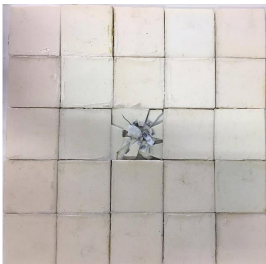
圖 11. 環氧樹脂為介面之破壞情形
