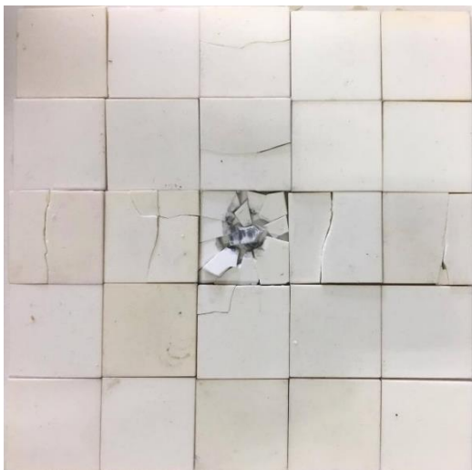
圖 10. 無介面破壞情形
