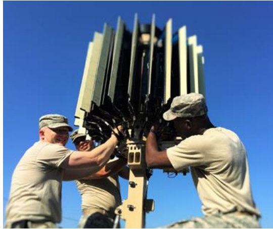
圖三 AN/MPQ-64「哨兵」(Sentinel) 防空系統雷達
