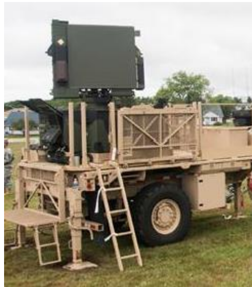
圖三 AN/MPQ-64「哨兵」(Sentinel) 防空系統雷達
