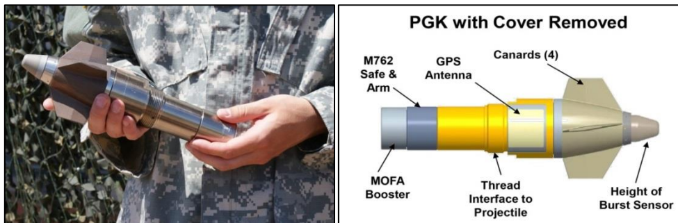
圖五 精準導引套件與 155 榴彈結合圖
