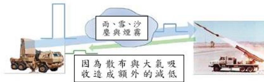
圖七 信號因大氣散布額外減低示意
