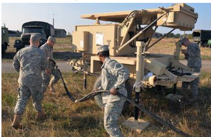
圖六 AN/TPQ-53 反火力戰目標獲得雷達
